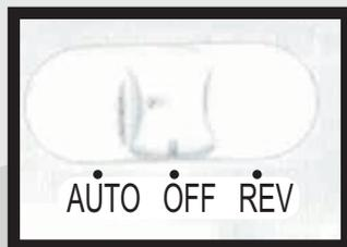
1 – Auto = Nesta posição a fragmentadora é iniciada automaticamente quando for inserido papel na abertura de fragmentação;
